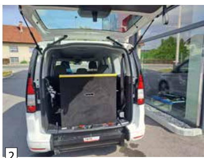
Poglobitev vozila z vitlom in dodatnim sedežem v VW Caddy-ju
