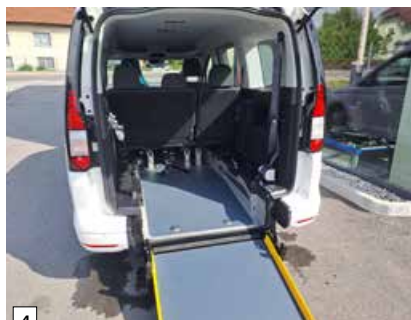
Poglobitev vozila z vitlom in dodatnim sedežem v VW Caddy-ju
